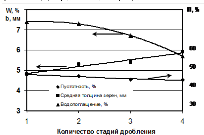
Рис. 1 – Влияние дробления на свойства вторичного щебня фр. 5-10 мм
